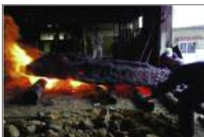
Fig. 3 : kera , éponge d'acier qui donnera tamahagane et shingane
