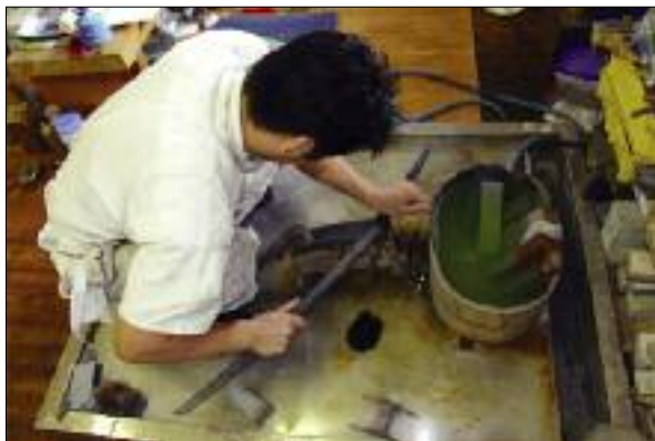
Fig. 16 : Le pied bride la pierre et le forgeron polit sa lame
