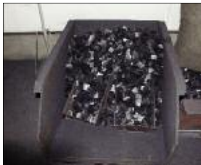
Fig. 7 : Le charbon de bois est calibré pour une chauffe homogène
