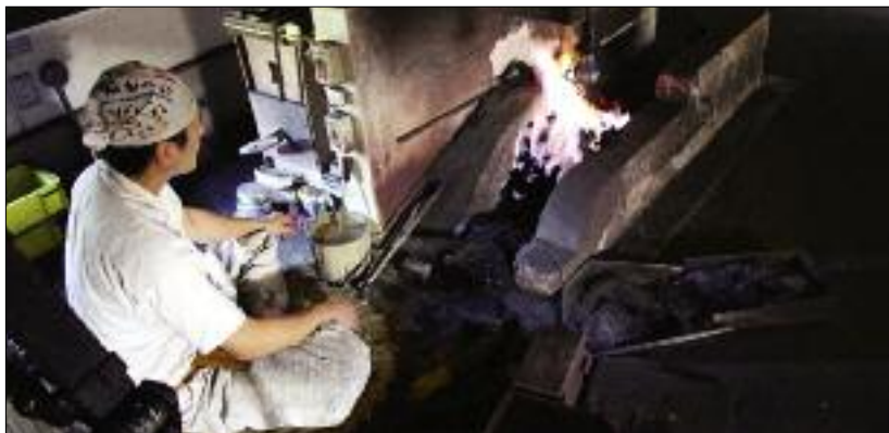
Fig. 5 : Poste du forgeron vu depuis son martinet : boue, hodo et sa ventilation, cendre de paille de riz, enclume et bac de trempe sont groupés à portée de main. A noter le levier sur l'enclume
